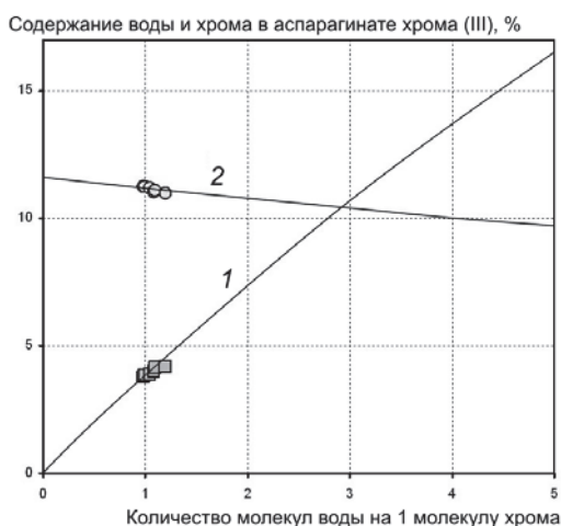
Рис. 1. Зависимость процентного содержания воды (1) и хрома (III) (2) от количества молекул воды на 1 молекулу хрома (III)
